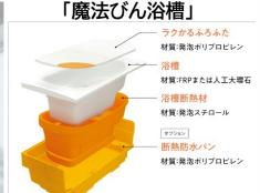
浴槽を断熱材で包み込んだ魔法びんの ような構造で、お湯のあたたかさを 保ちます。
