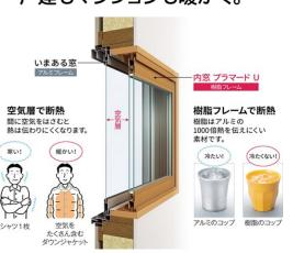
今ある窓と内窓の間に空気層ができることで、 冷たい外気の影響を受けにくくなります。 熱を伝えにくい樹脂のフレームが、 さらに断熱効果を高めます。
